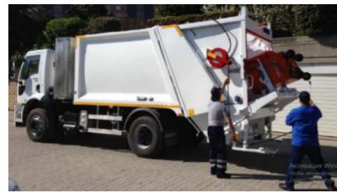
Фото. Смітєвоз HIDRO MAK з функцією миття та дезінфекції контейнерів
