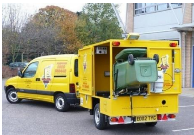
Фото. Обладнання для миття контейнерів на причепах
